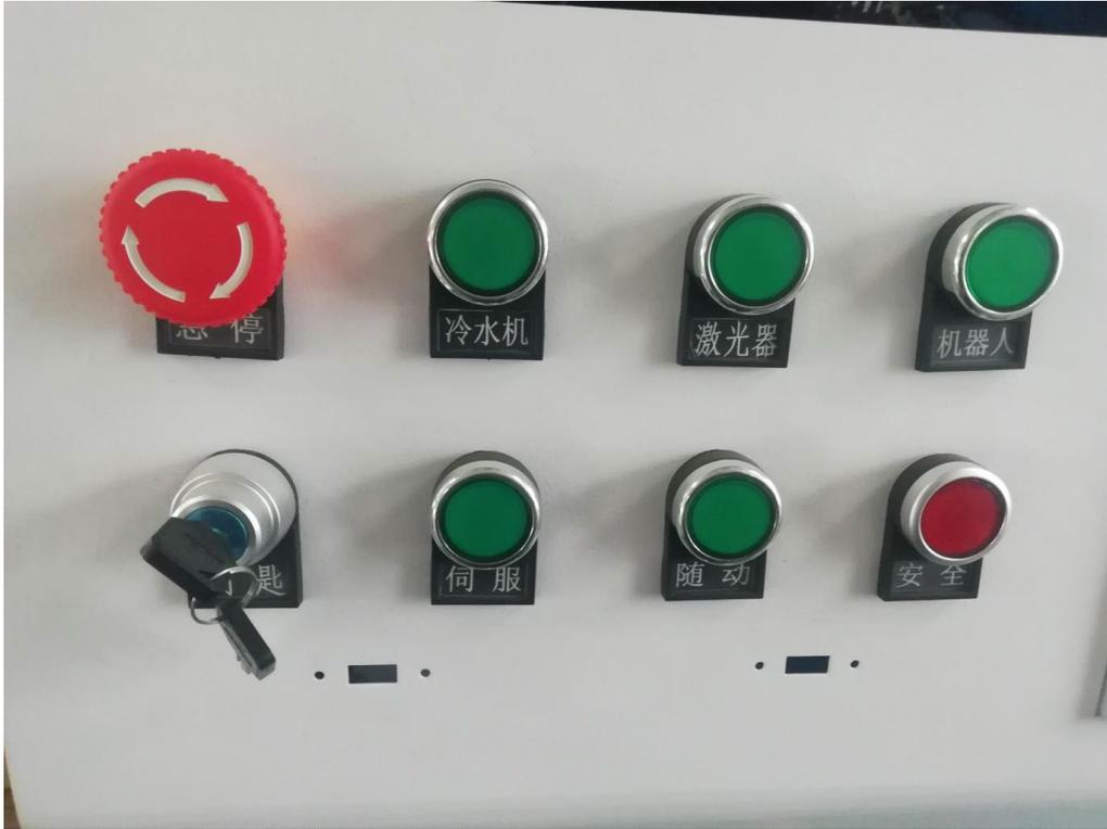
**开机顺序** 合上空气开关——打开急停开关——打开钥匙开关——打开冷水机开关 等待 10 秒 ——打开激光器开关 等待 10 秒 ——打开机器人——打开伺服开关——打开随动开关
