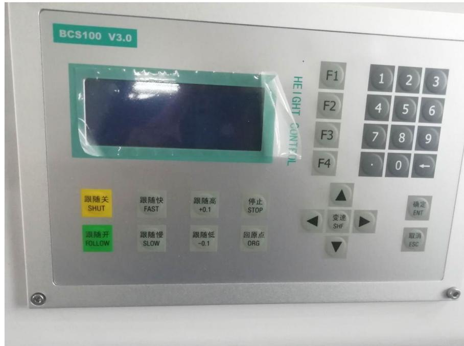
BCS100 型调高器为电容式调高器 激光切割包括平板切割都采用电容式调高器 其工作原理如下
