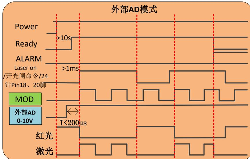
图 14 外部 AD 模式控制时序图
