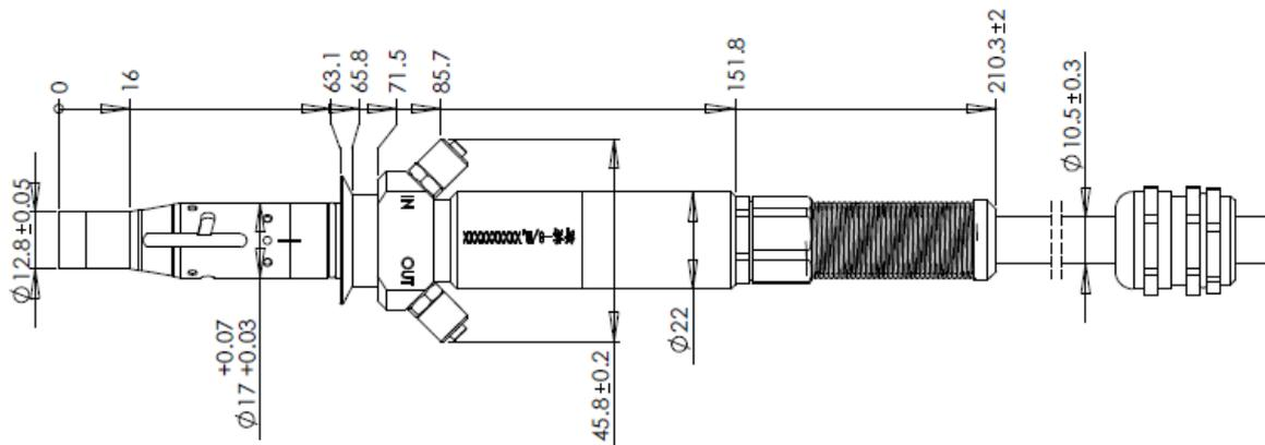
图 3(b) iQB 输出光缆尺寸图(单位:mm)
