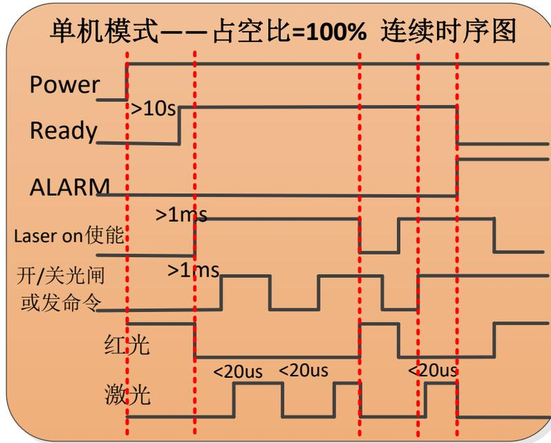
图 12 单机模式——连续控制时序图
