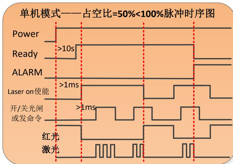
图 13 单机模式——脉冲控制时序图
