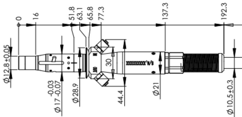
图 3(a) QBH 输出光缆尺寸图(单位:mm)
