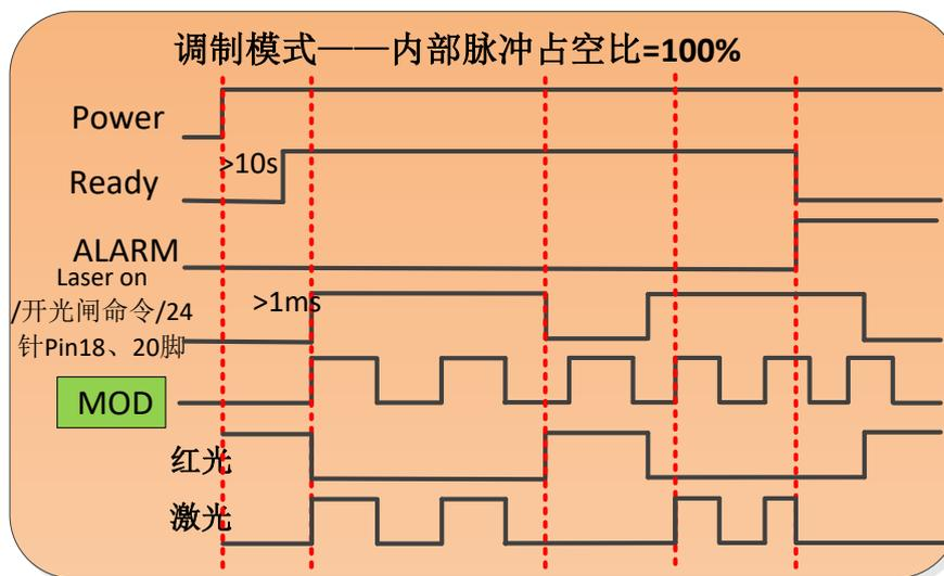
图 15 调制模式控制时序图
