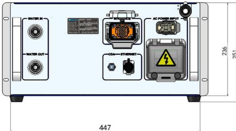
图 2 (b)后视图(单位: mm)
